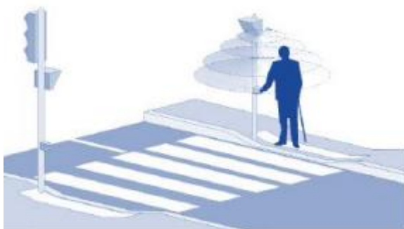
Рисунок 3.19 – Примеры размещения направленности действия технических средств звуковой сигнализации на регулируемых пешеходных переходах
