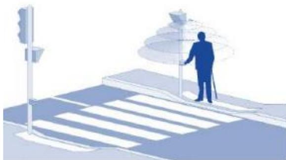
Рисунок 2.13 – Примеры размещения направленности действия технических средств звуковой сигнализации на регулируемых пешеходных переходах
